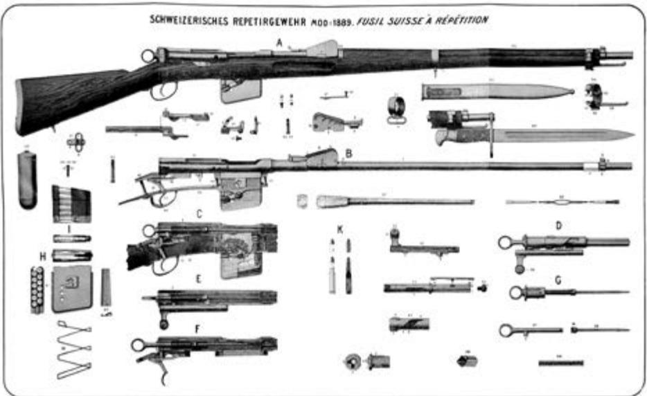
Le fusil suisse à répétition Modèle 1889 fonctionne selon le principe de la culasse à mouvement rectiligne développé par le colonel Rudolf Schmidt. (© wikipédia)
